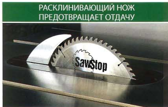
Расклинивающий нож устанавливается позади пильного диска, поднимают и опускают вместе с ним. Это устройство удерживает две плоскости распила на некотором расстоянии друг от друга и таким образом предотвращает отдачу.
