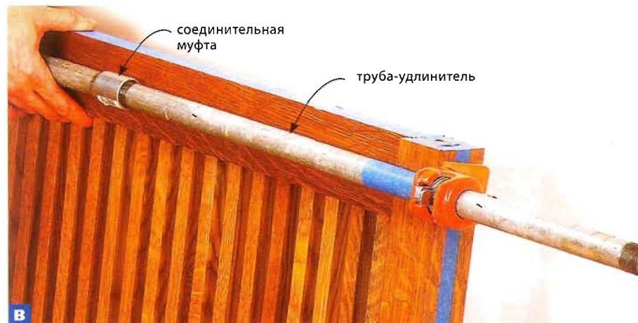
Для габаритных склеек удлините трубные струбины дополнительными отрезками трубы с помощью муфт. Синий малярный скотч защитит древесину от контакта с металлом трубок и клея.
