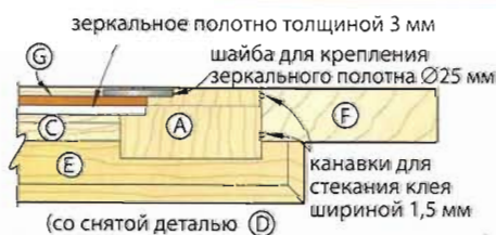
РИС. 3. РАМА В РАЗРЕЗЕ (ВИД СВЕРХУ)
