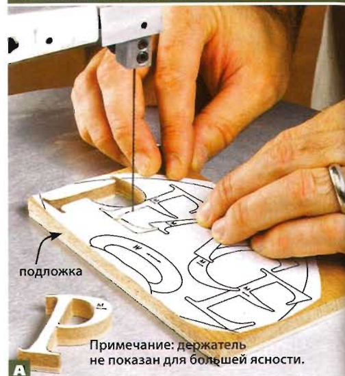
Используя подложку для предотвращения сколов, выпилите буквы из заготовок. В буквах «Р» и «А» выпилите сперва внутренние участки.
