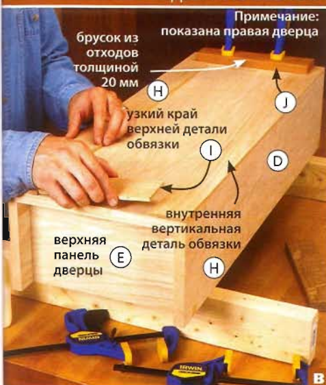
Используйте брусек из отходов толщиной 20 мм для равномерного распределения давления струбцин. Приклейте детали обвязки H, I, J к передней панели дверок внешними краями заподлицо.
