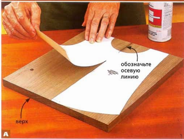
А Совместите и приклейте половинки лекала на каждую стенку А, положив одну половинку лицом вверх, а другую – лицом вниз.
