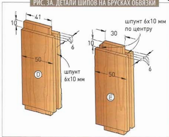
РИС. 3А. ДЕТАЛИ ШИПОВ НА БРУСКАХ ОБВЯЗКИ
