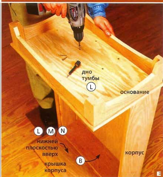
Для присоединения основания к корпусу просверлите монтажные отверстия сквозь дно тумбы L в дне корпуса B и закрутите шурупы.
