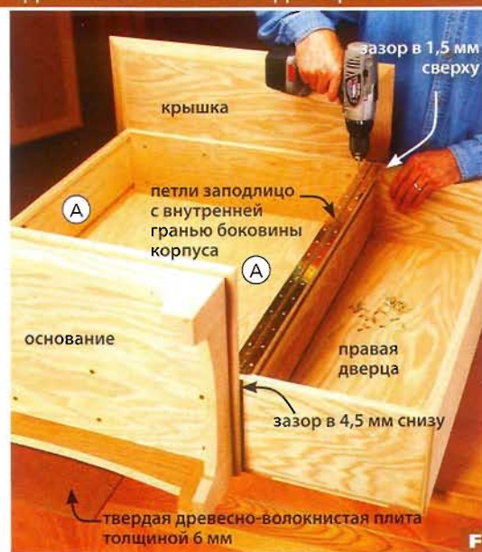
Установив корпус на твердую древесно-волокнистую плиту толщиной 6 мм и выровняв дверцы относительно корпуса, просверлите монтажные отверстия и прикрепите петлю шурупами к корпусу.
