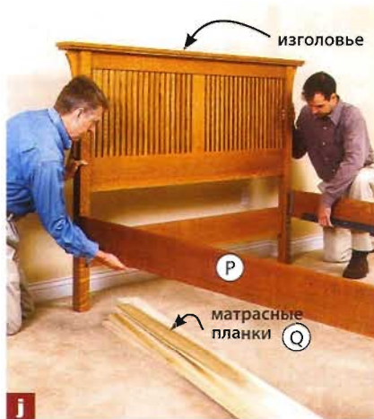
1 Соедините боковые доски с изголовьем кровати, сцепив детали стальных стяжек-фиксаторов. Затем точно так же установите изголовье.
