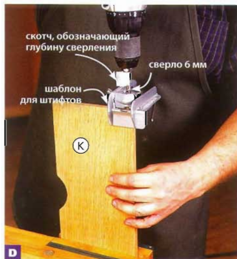
Используя шаблон для шкантов, установите сверло по центру кромки передней стенки по толщине фасада ящичка K. Просверлите отверстия 6x18 мм на расстоянии 9 мм от нижней кромки ящичка для осевых штифтов.
