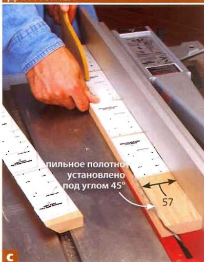
Установив пильное полотно циркулярной пилы под углом 45° к вертикали, отпилите заготовку для ножек шириной 57 мм.
