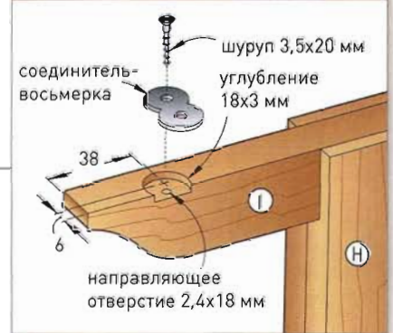
РИС. 2А. УСТАНОВКА СОЕДИНИТЕЛЕЙ-ВОСЬМЕРОК
